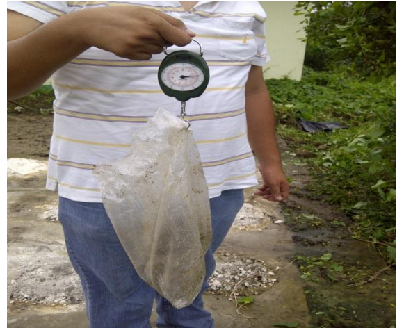
6- B PESADO DEL LODOD ESTABILIZADO
