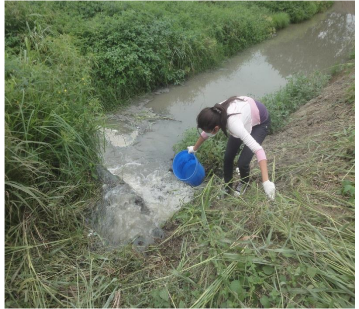
Medición de caudal en el canal de conducción del agua residual (horas de la mañana y noche)
