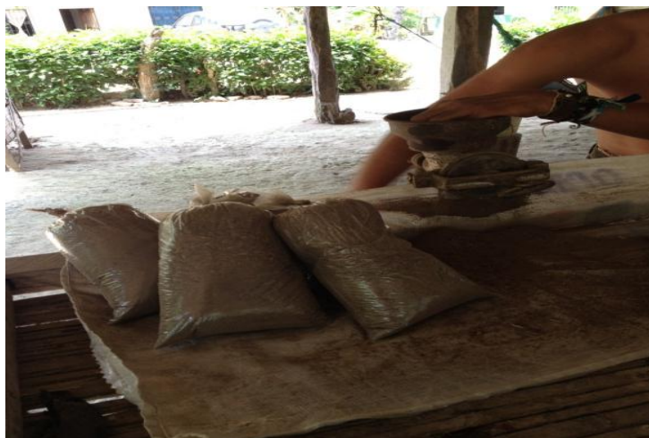
Fotografía 3: Molido de la muestra en molino manual
