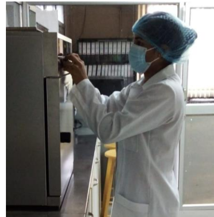
Anexo 12. Ingreso a la estufa para prueba de determinación para pérdida de peso..
