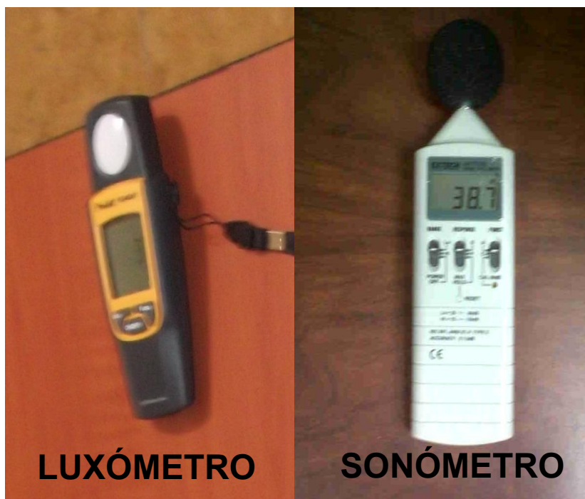
Foto 3.1. Equipos para la toma de medidas de los factores del entorno laboral Fuente: Elaboración propia.
