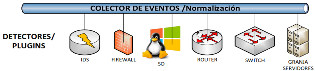
Figura 12 Ossim colector de eventos Fuente: Autores
