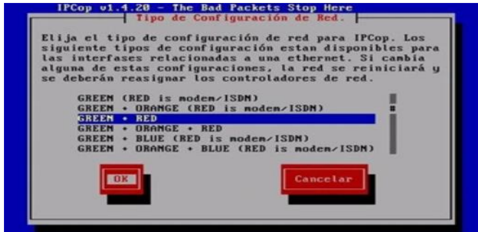
Figura 57. Configuración interfaces IPCOP
