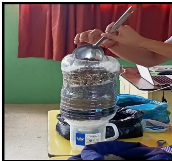
**Figura 7.30.** Colocar una capa de grava de 15 cm.
