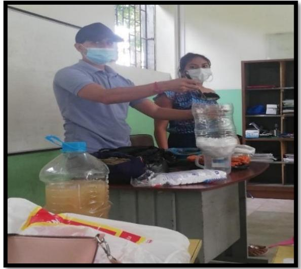
**Figura 7.26.** Colocar una capa de carbón activado de 3 cm.
