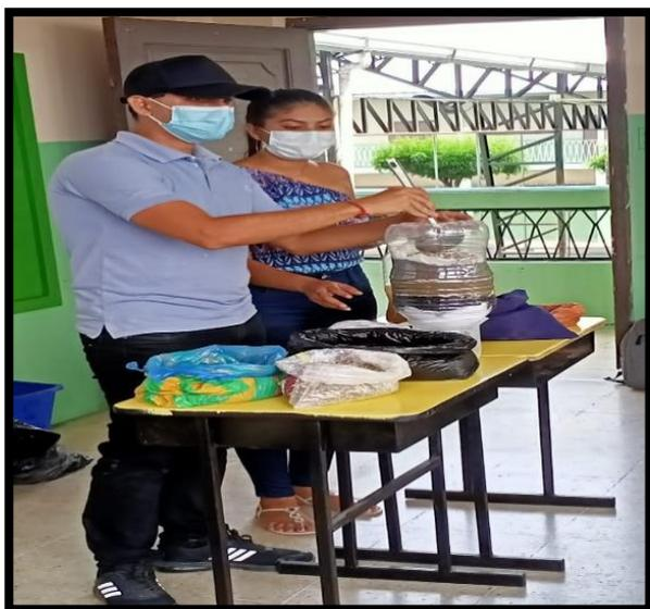
**Figura 7.292.** Colocar una capa de grava de 10 cm cm.
