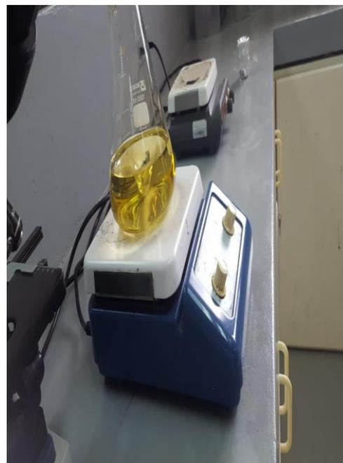
Colocación en el agitador magnético
