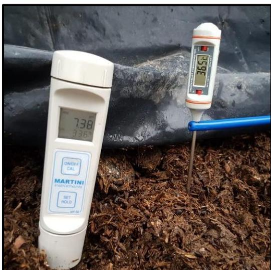
**Fotografía 11.** Medición de temperatura y pH.
