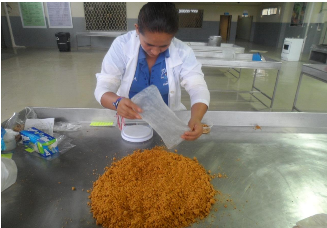
Foto m. Adición del antioxidante (ácido ascórbico)
