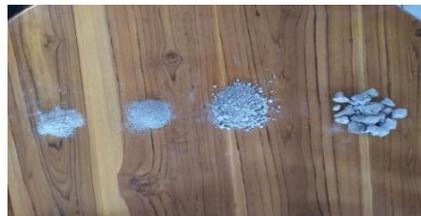
Foto 5. Obtención del material granular para el filtro de piedra pómez y grava
