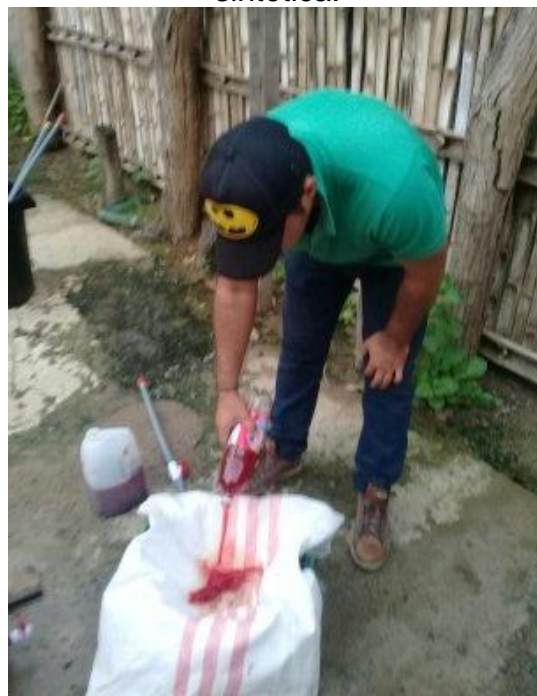
Anexo 8d. Pre filtración del agua residual.
