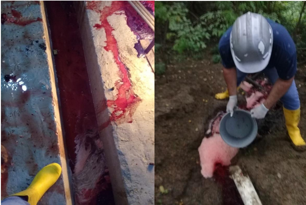
Anexo 6a. Medición de los caudales del agua residual del centro de faenamiento.
