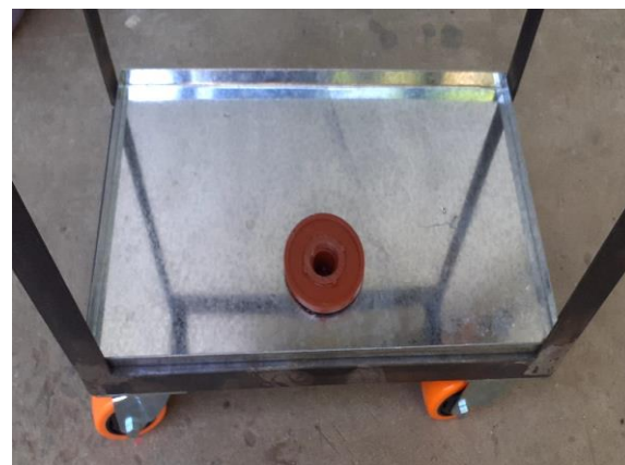
3-F. Reservorio de agua.
