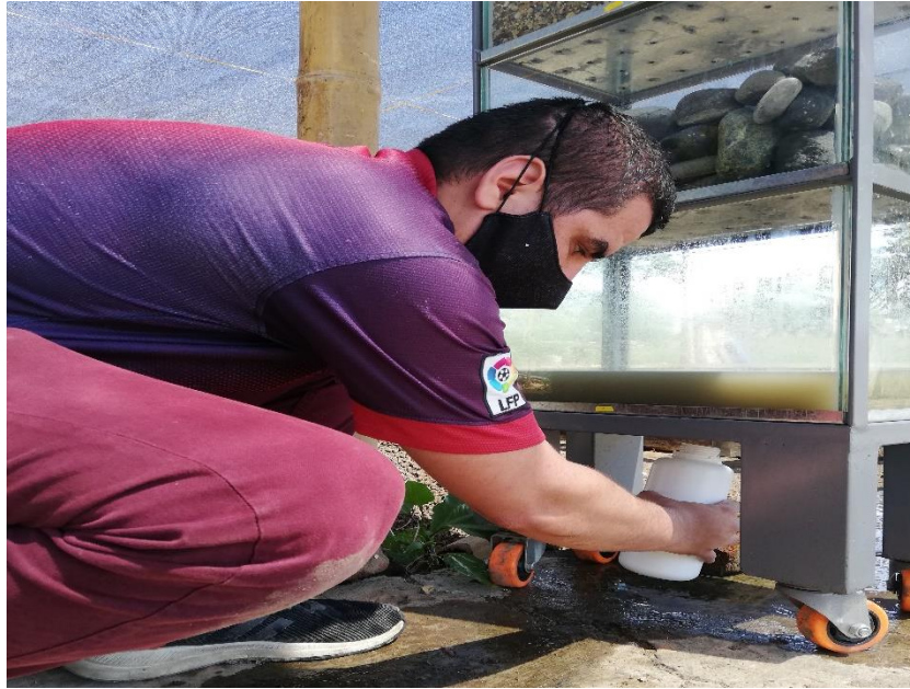
11-A. Toma de muestras del agua residual doméstica tratada.
