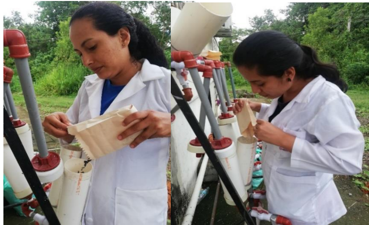
Foto 2. Distribución del material filtrante dentro de los filtros
