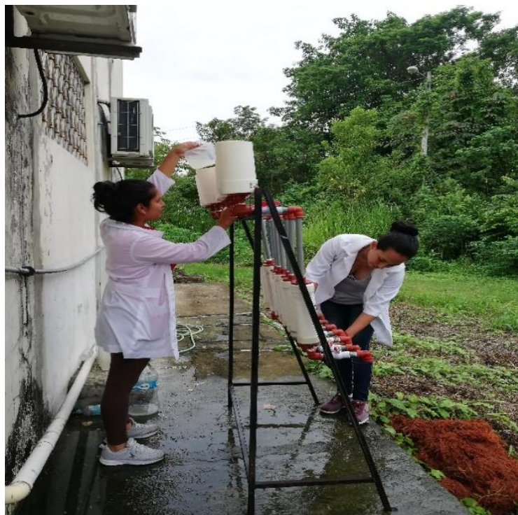
Foto 7. Recolección del agua residual después de su travesía dentro del filtro
