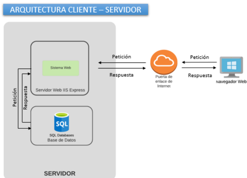
Figura 3.3. Diagrama de la Arquitectura Cliente - Servidor Fuente: Los Autores.
