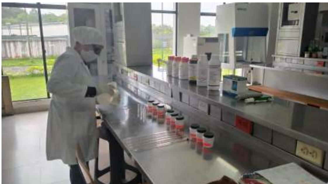
**Ilustración 3.** Preparación de las soluciones de Biocidas (Cid 20, Vanodine y Amonio cuaternario)
