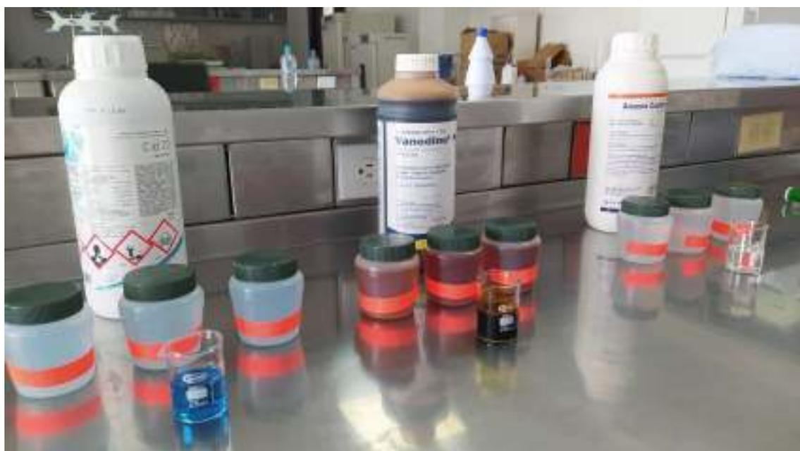
**Ilustración 4.** Soluciones de biocidas listas en diferentes concentraciones
