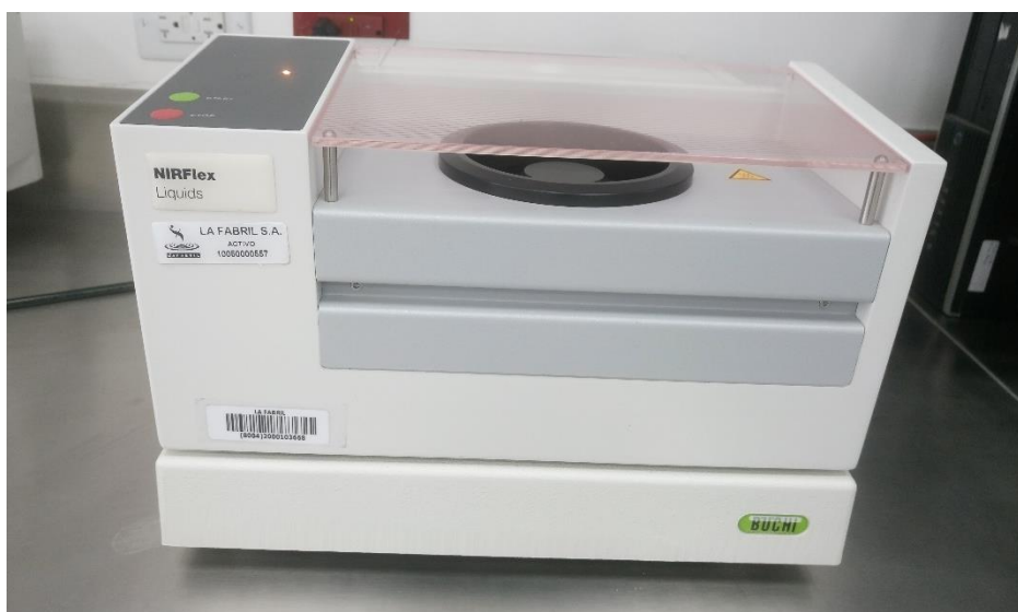
Figura 3: Equipo NIRFlex N-500 Fuente: Autores de la investigación.
