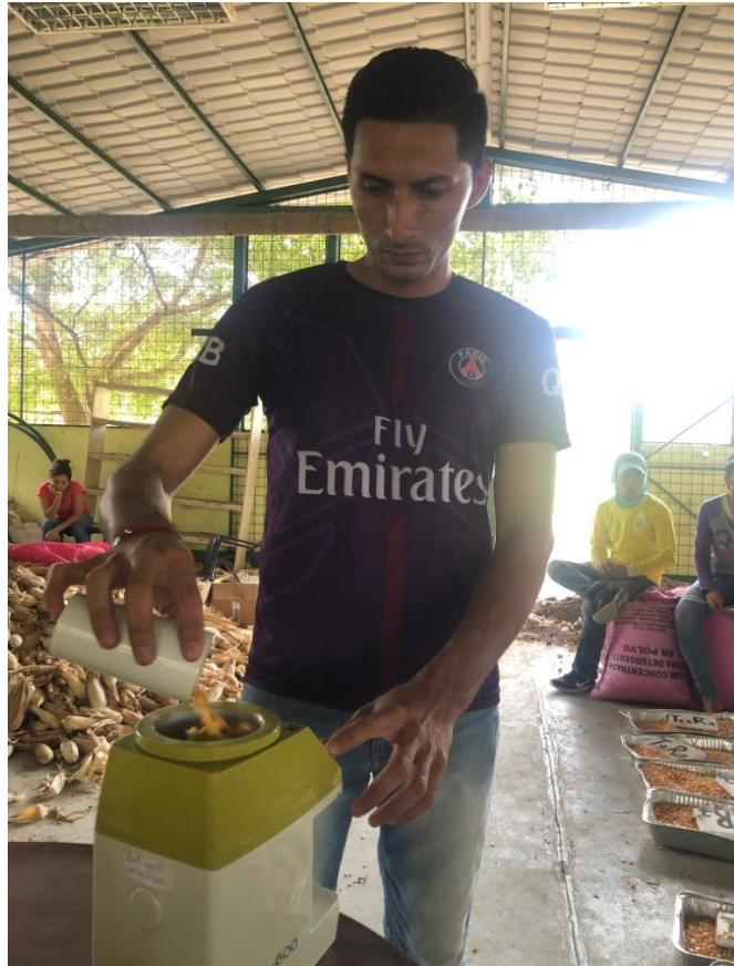
Anexo23. Toma de datos de la humedad del grano en el maíz.
