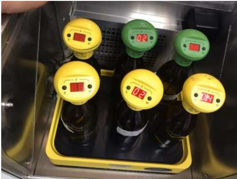
Anexo 5. Muestra de DBO 5 en la incubadora a 20 °C
