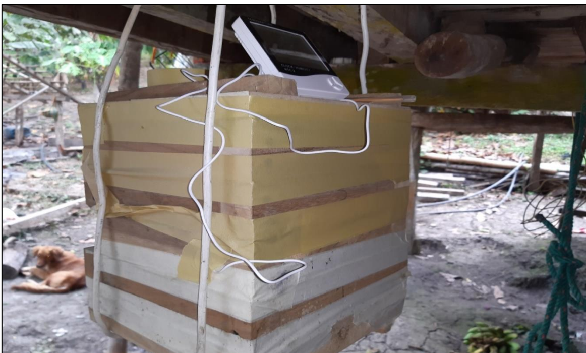
Anexo 10. Toma de temperatura de la caja estandarizada construida con madera de pechiche ( Vitex gigantea )
