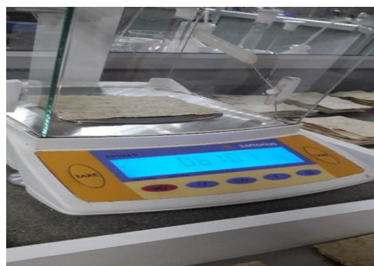
Anexo 2.6. Toma del gramaje después del horno y desecador
