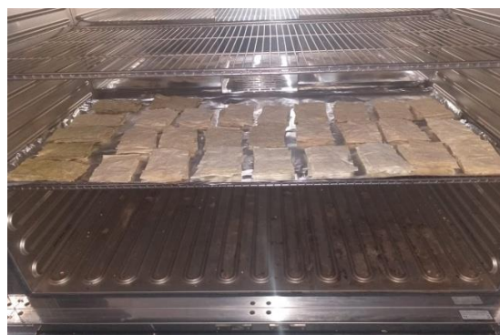
Anexo 2.4. Secado de las muestras en el horno eléctrico
