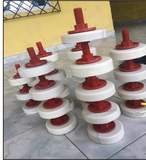
Anexo 2-H Acoples de biofiltros
