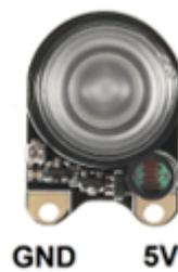
Figura 4. 9. Polaridad de los focos IR (infrarrojos)
