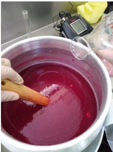
2-C Punto isoelectrico para precipitación
