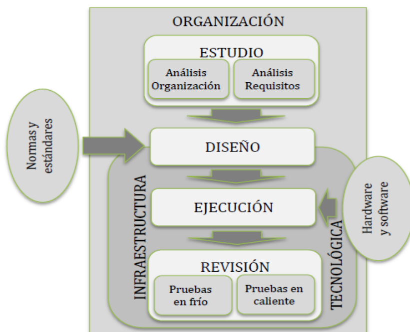
Figura 3. Esquema de la metodología EDER Fuente: (Morales et al. 2018).
