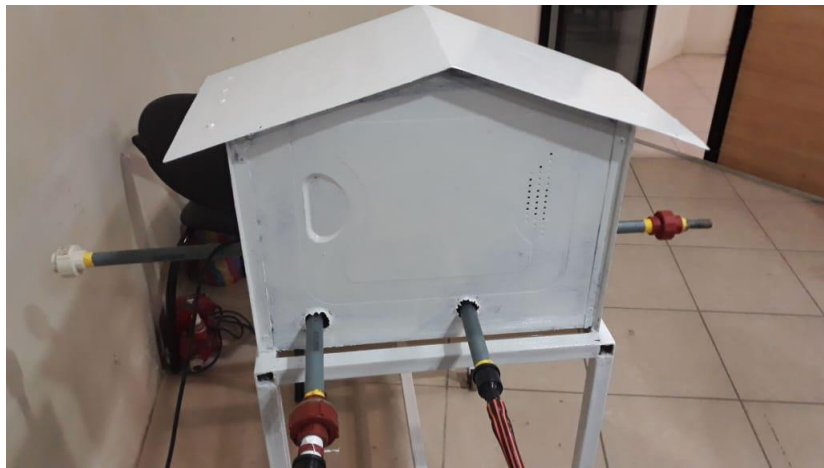
Imagen 5. Protección de nodo controlador
