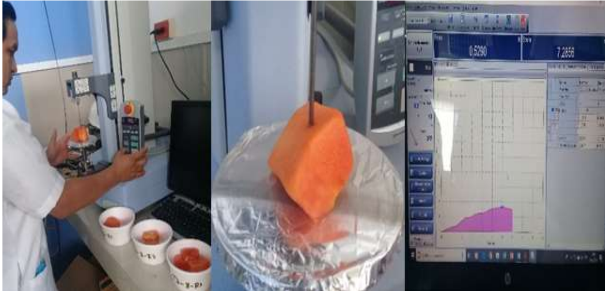
Foto 3. Análisis de firmeza en trozos de papaya en texturómetro marca Shimadzu (Modelo EZ LX, Japón). De acuerdo a la metodología (Castro, Rivadeneira, Santacruz y Ziani, 2014)
