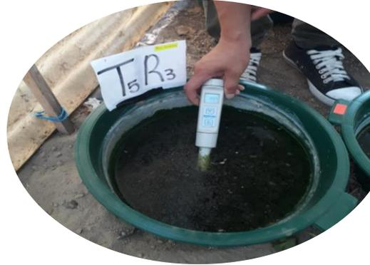
Foto1 – Foto2. Reactores de 5.48 litros, forma redonda, material plástico.
