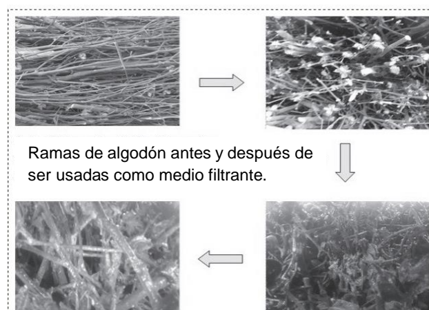
Figura 2. 2 Ramas de algodón como medio filtrante para filtro percolador. Fuente (Aslam et al. , 2017)
