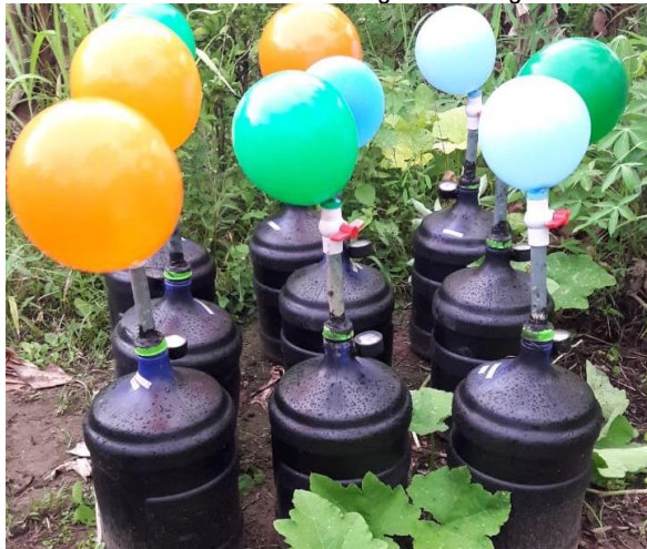
Anexo. 19. Producción de biogás en biodigestores
