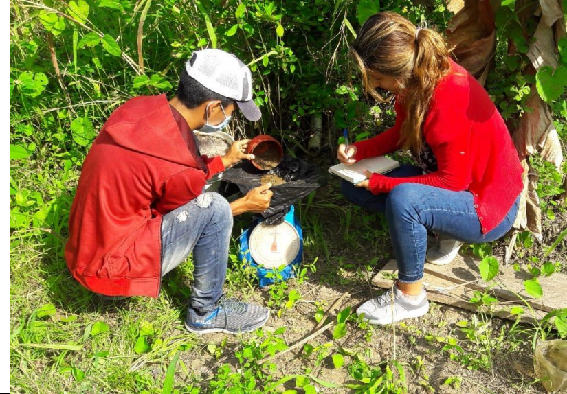
Anexo. 22. Peso del volumen de los residuos semisólidos de la mezcla.
