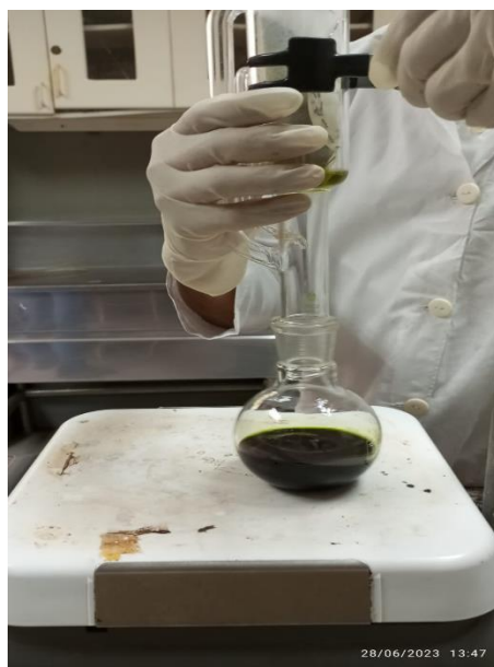
Anexo 12. Extracción en el equipo Soxhlet
