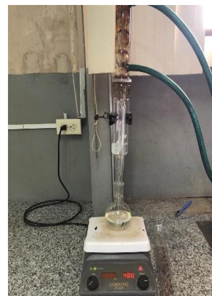
Anexo 2-F. Determinación de grasa (Soxhlet).
