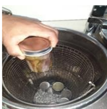
Foto 3-H. Esterilización envases de vidrio en autoclave a 121°C
