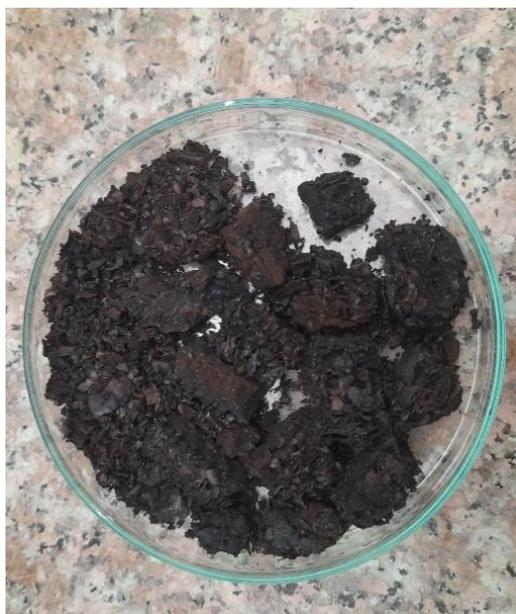
Anexo 1-D. Trituración, para la obtención del hidrocarbón
