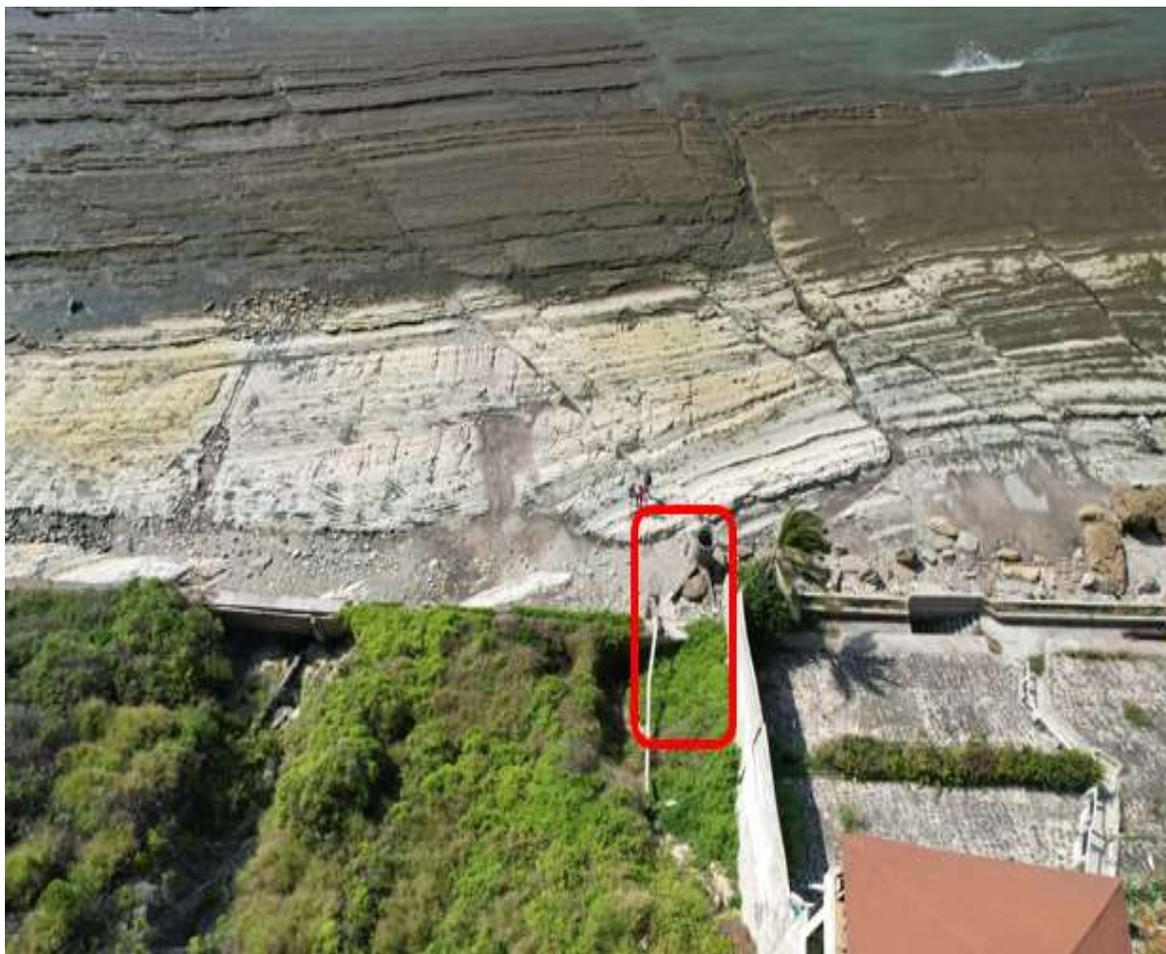
En el extremo de la playa, colindando con el espigón de Barbasquillo se capturó la figura 4.4 en la que se alcanza a divisar una pluma de vertido procedente de un ducto público de aguas lluvias, en el que visualmente se constató que sus aguas son grises y de mal aspecto.
