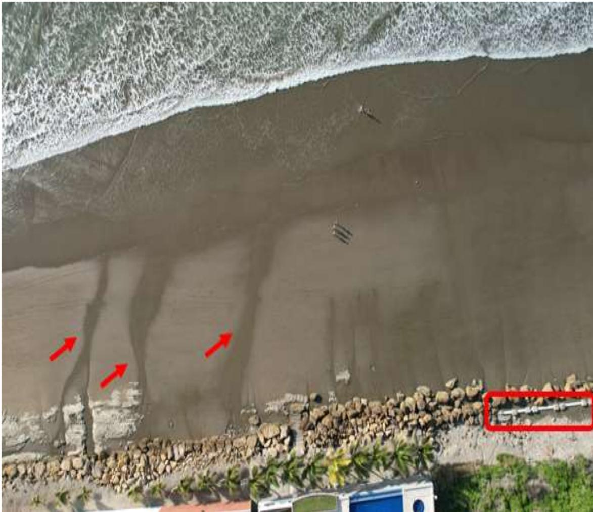
Por su parte, la figura 4.2 es una imagen captada junto a la estación de bombeo Umiña. Cercana a ella, existen dos vertidos: uno de ellos propio de roturas en la red de tuberías que se conectan a la estación y una segunda descarga procedente de una tubería clandestina que emerge por el talud cubierto de vegetación.
