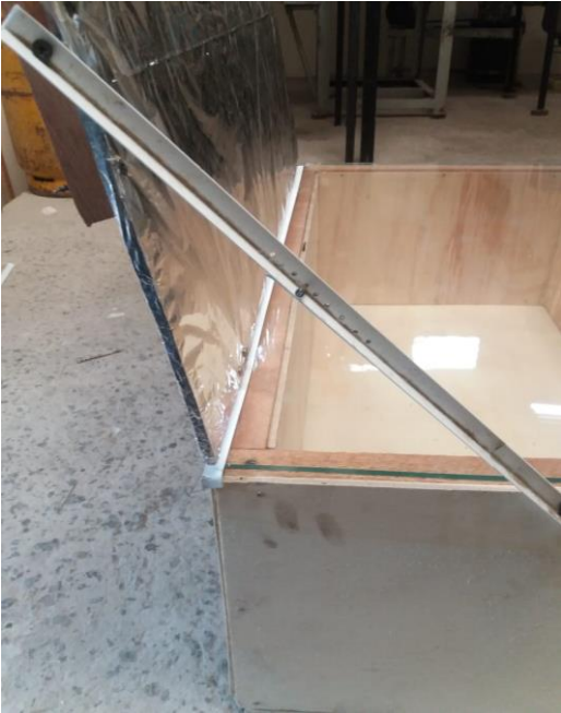
Anexo 3.9. Colocación del ángulo de aluminio para la orientación del sol
