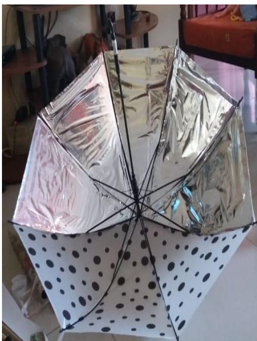
Anexo 3.15. Colocación del material reflectante mylar
