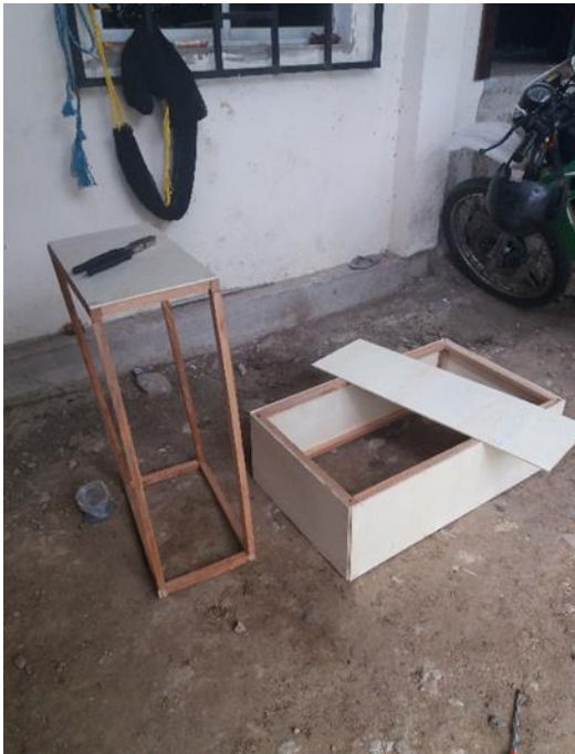
Anexo 3.3. Armado de la estructura interior y exterior del horno solar tipo caja.
