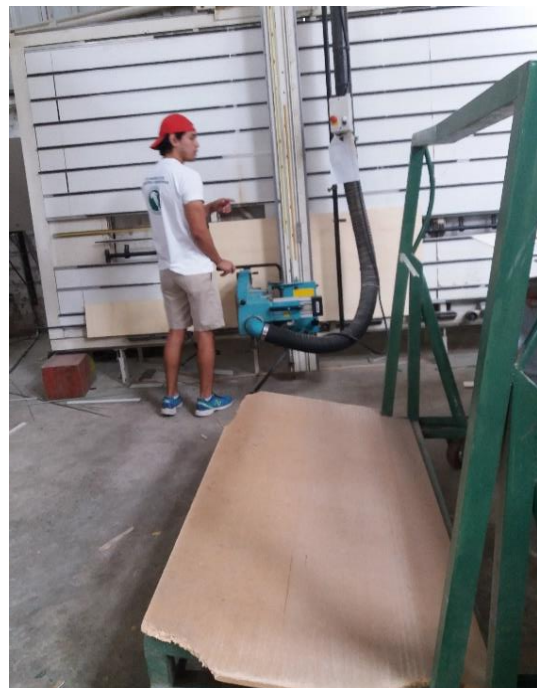
Anexo 3.4. Corte de la plancha del plywood a las medidas requeridas.
