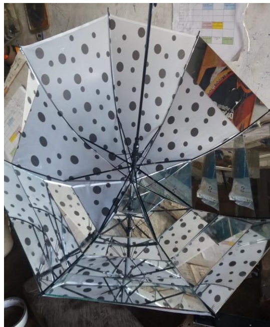
Anexo 3.14. Colocación del material reflectante vidrio
