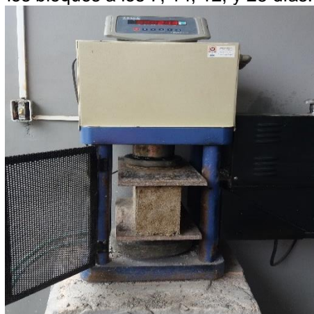
Anexo 7-A. Ensayos de compresión de los bloques a los 7, 14, 12, y 28 días.
