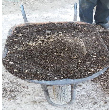
Anexo 6-C. Preparación de la mezcla con tusa, tallo y hojas de maíz.
