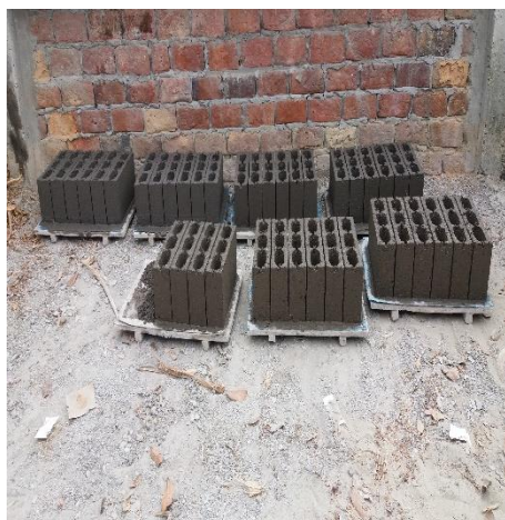
Anexo 6-G. Curado de los bloques al medio ambiente.
