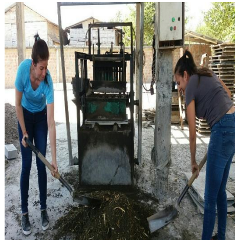
Anexo 6-E. Colocación de la mezcla en el molde.
