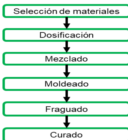
Figura 4. 1. Diagrama de elaboración de los bloques para la construcción con residuos del cultivo del maíz.
