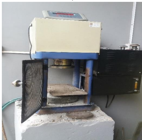
Anexo 7-A. Máquina de prueba de compresión.
