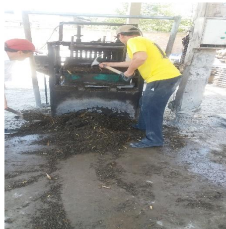
Anexo 6-E. Colocación de la mezcla en el molde.
