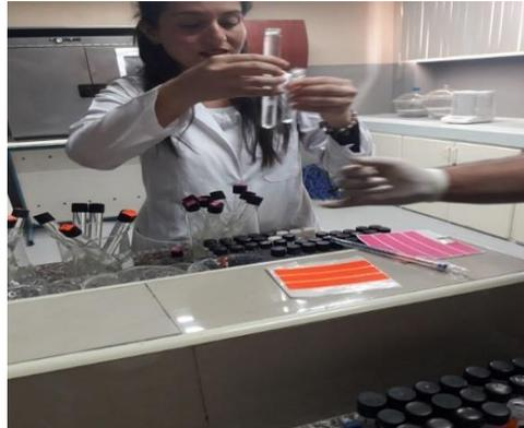
**1.M.: Aforacion de las soluciones con agua desmineralizada.**
