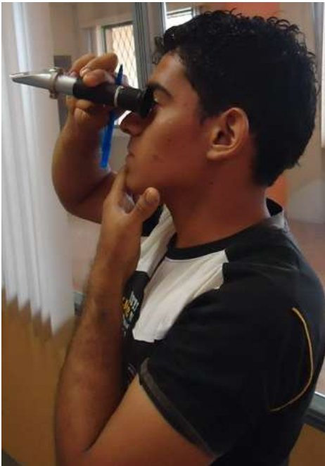
Foto 16.3 Visualización de los porcentajes de los sólidos solubles mediante el refractómetro.
