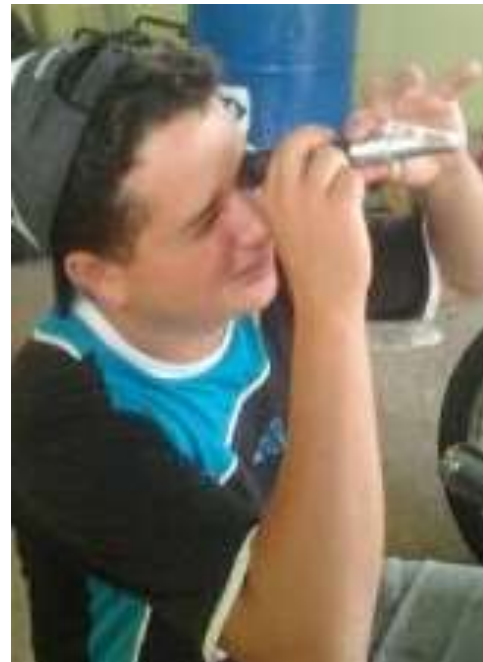
Foto 16.3 Visualización de los porcentajes de los sólidos solubles mediante el refractómetro.
