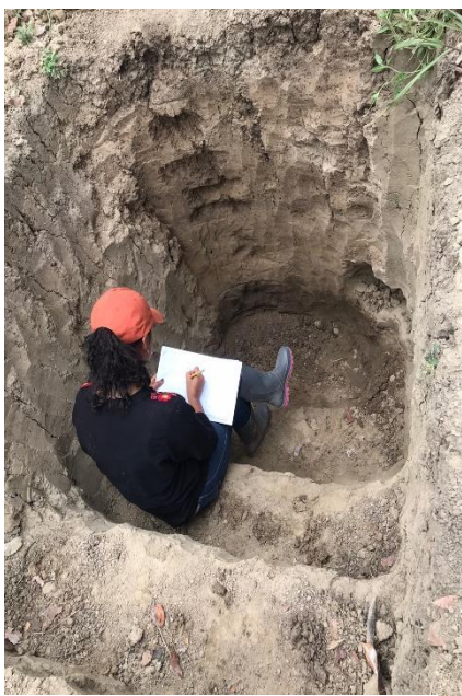
Anexo 6. Toma de datos de la calicata general
