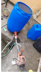
9. Implementación de bomba de impulsión para inicio de ensayo de filtración forzada
