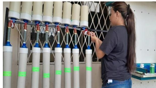
6. Ensamblando los filtros a la base
