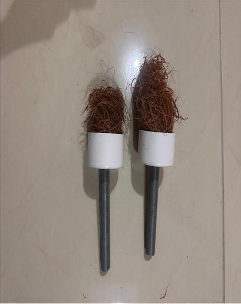
**Foto 15.** Implementación del medio filtrante en el tubo PVC.
