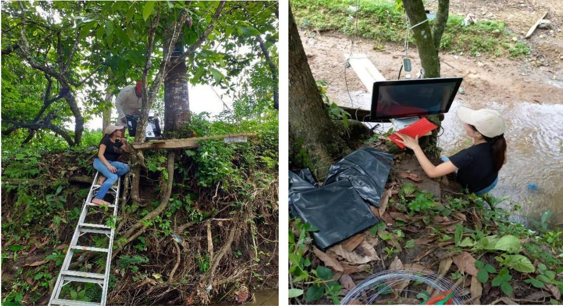
**Anexo 1.A.** Instalación y comprobación del funcionamiento de los equipos de monitoreo del caudal en Platanales.
