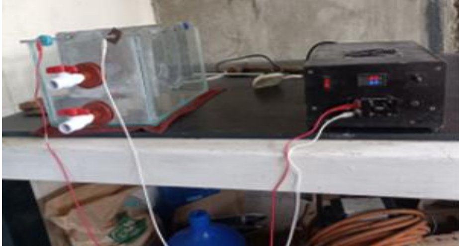
Anexo 3. Sistema de electrocoagulación.
