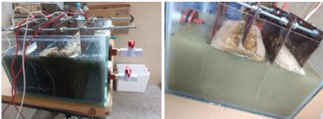
Anexo 7. Tratamiento de agua residual con electrodos de hierro.
