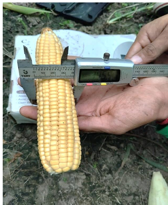
Anexo 6. Toma de datos de diámetro de mazorca sin bráctea con calibrador digital
