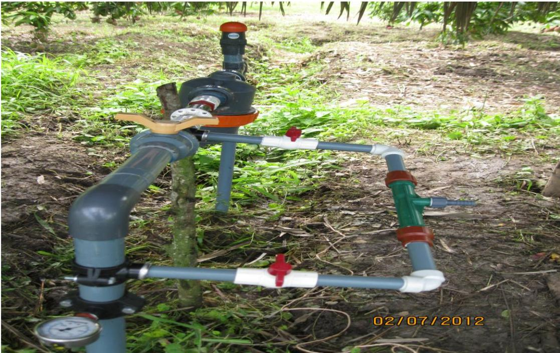
Foto 2 inyector Venturi
