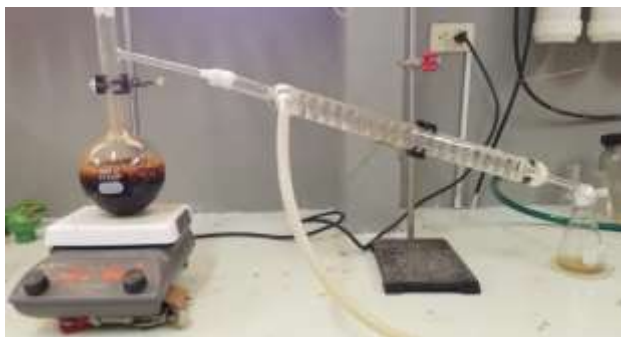
9-D. Destilación del mosto con tubo refrigerante en espiral.
