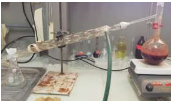
9-C. Destilación del mosto con tubo refrigerante en bolas.
