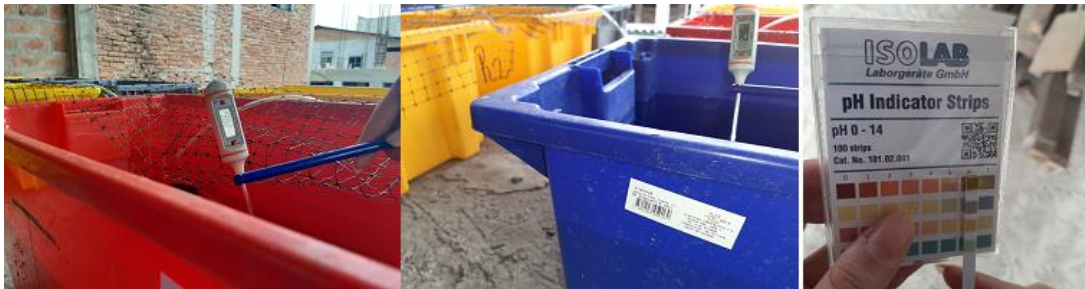
Anexo 8.N. Medición de la temperatura y pH del agua.
