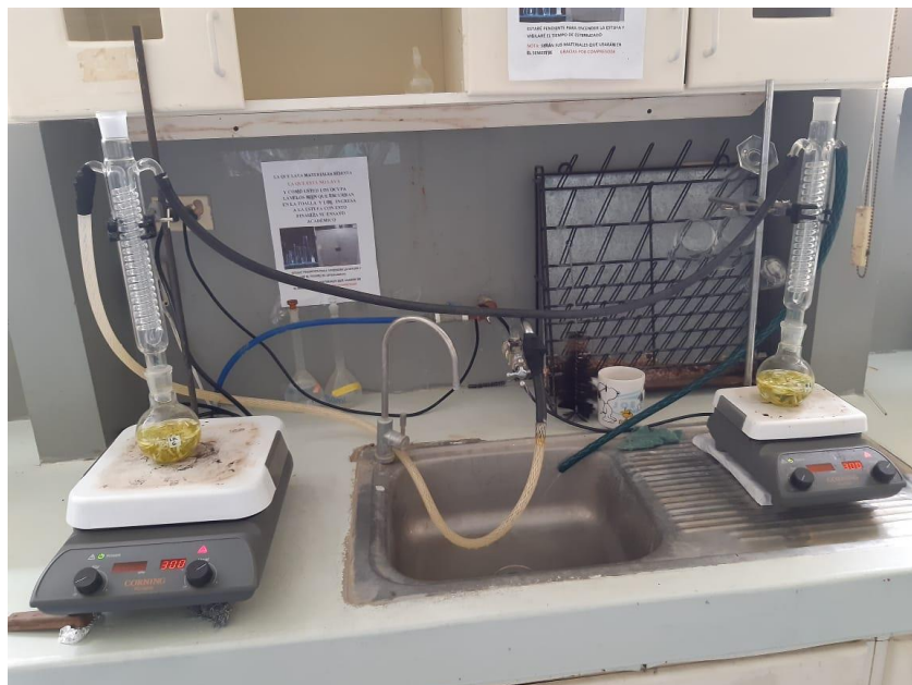
Imagen 8.3 Método de extracción directa a reflujo.
