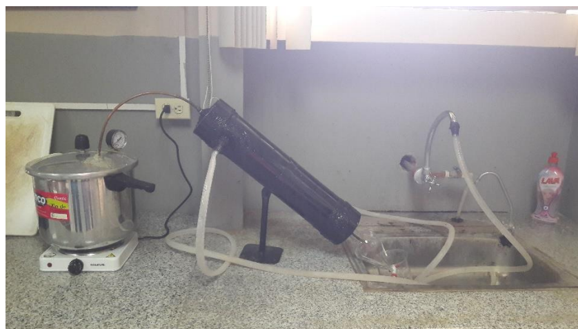
Imagen 8.2 Método de extracción por destilación.
