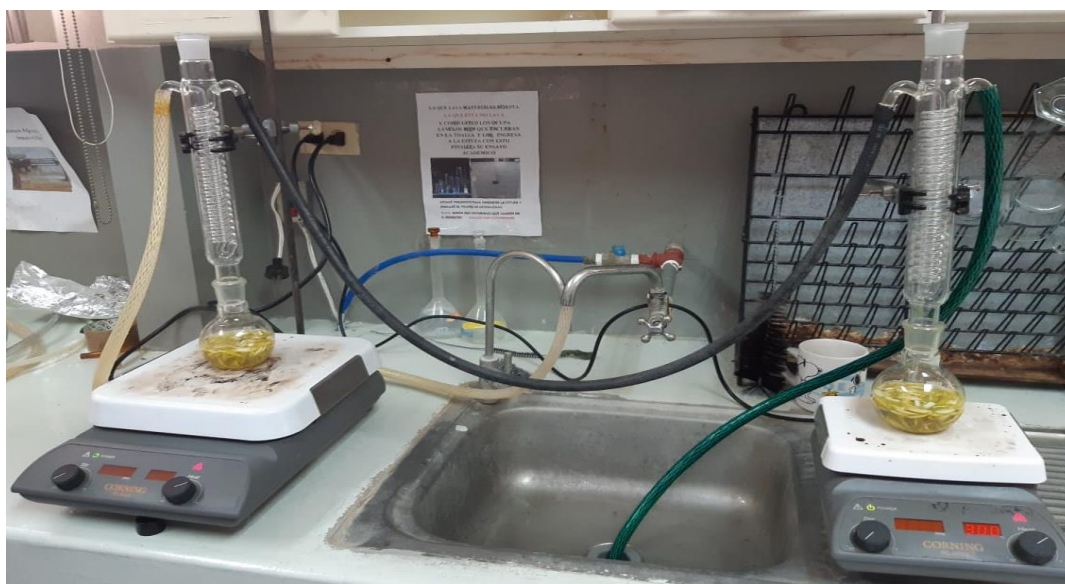
Imagen 2.5 Método de extracción directa a reflujo.
