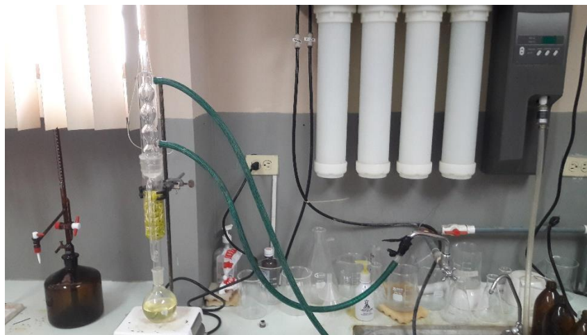
Imagen 8.1 Método de extracción por Soxhlet.
