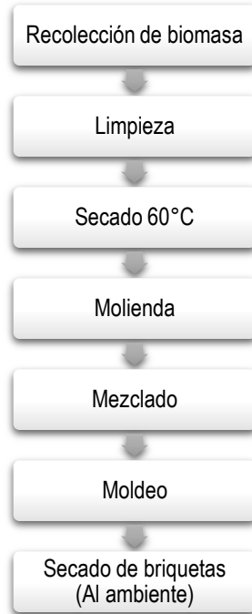
Figura 3. Esquema del proceso de briquetado seleccionado. Fuente: Adaptado de Fonseca y Tierra (2011).
