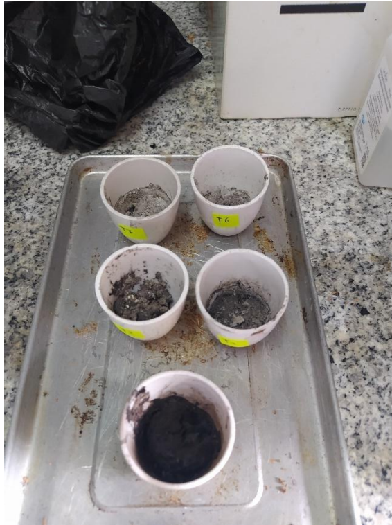
Anexo. 5. Proceso para la determinación de SV/ST
