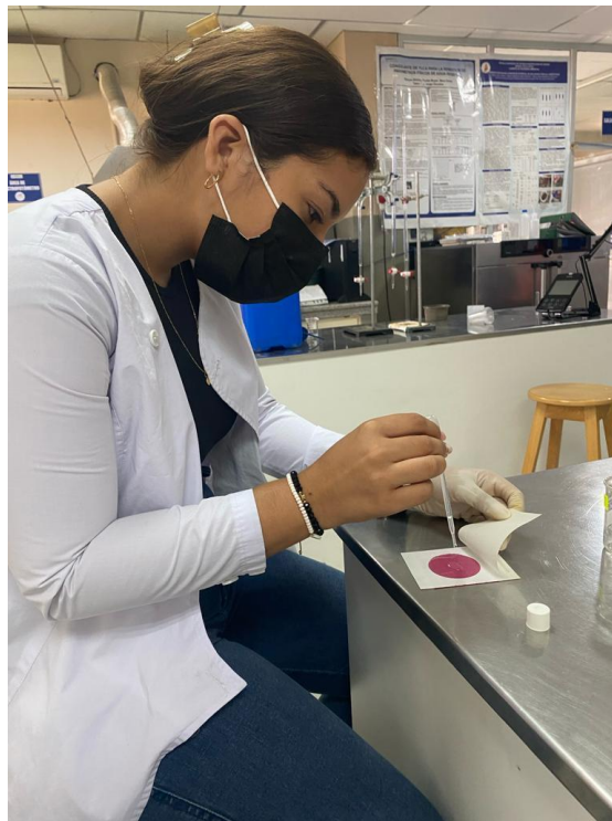
Anexo. 7. Aplicación de muestra residual en placas Petrifilm para el análisis de coliforme fecales
