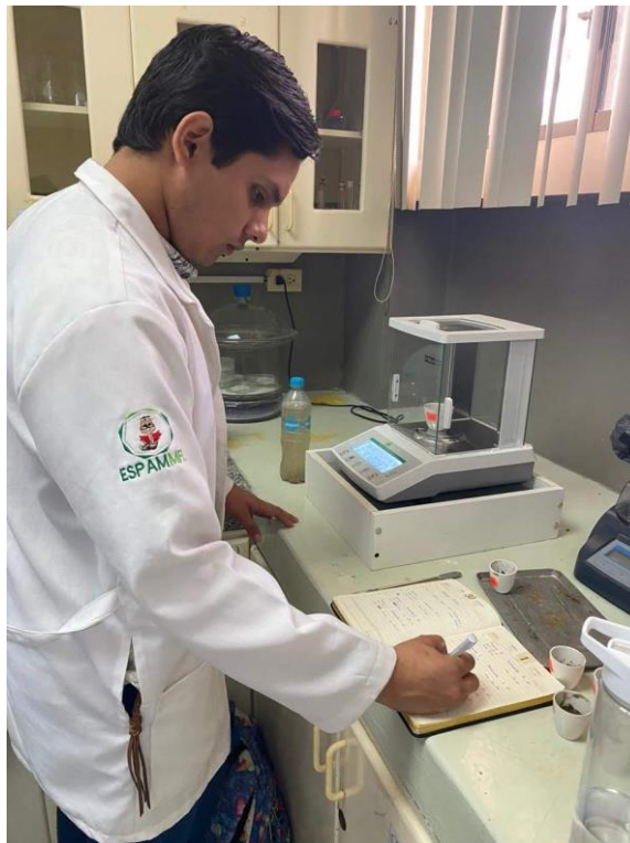
Anexo. 6. Pesaje de cápsulas en el proceso de cálculo de SV/ST.
